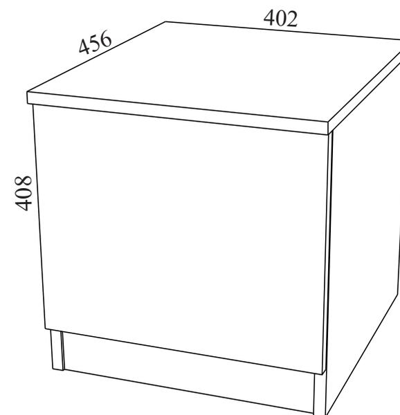
Габаритные размеры: длина - 402 мм, высота - 408 мм, глубина - 456 мм.
